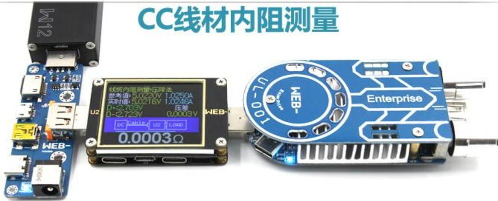
1 U2连接电源和恒流负载，电流调到1A左右，按OK键记录参考值
