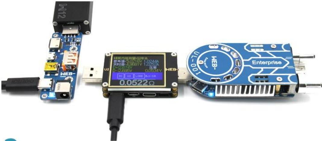
2 电源与U2之间串入待测线材，即可通过压降测试线材内阻
