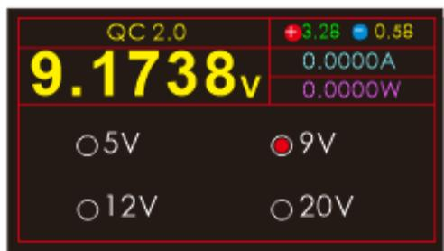
红色圆形+: D+端口电压（单位: V）
